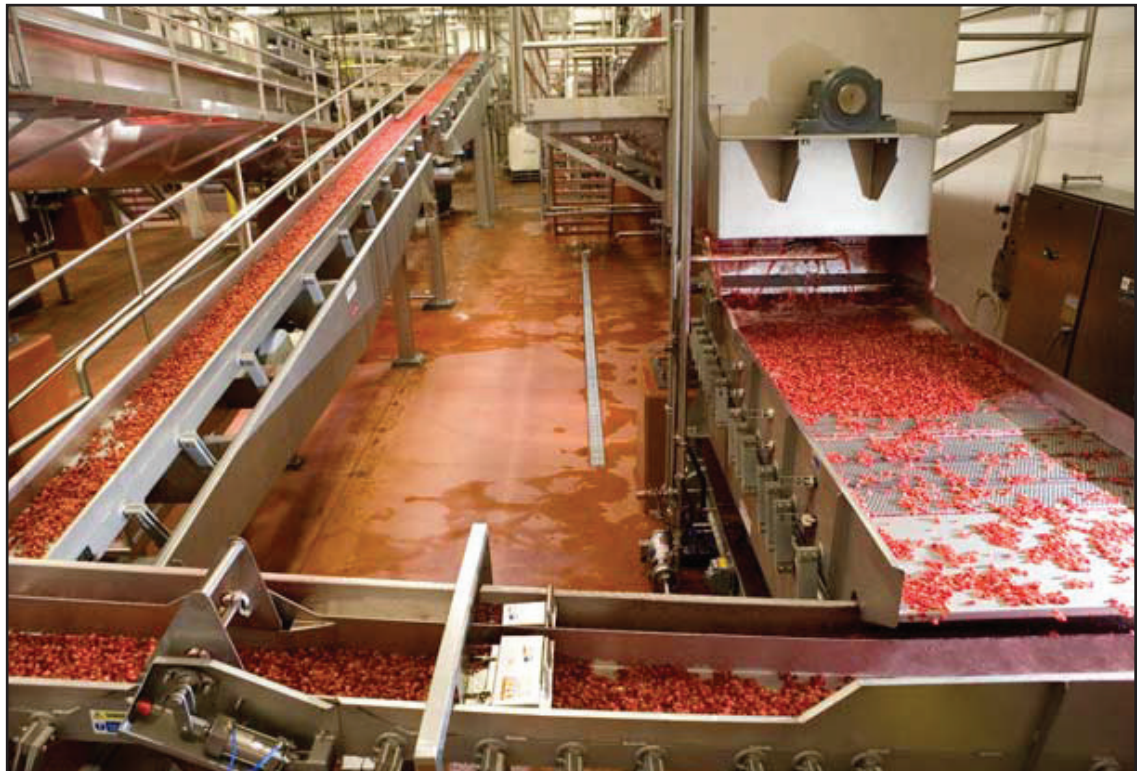
Les convoyeurs vibrants Iso-Flo font partie intégrante de la ligne de process sanitaire d'Ocean Spray.
