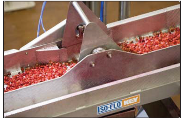
Ce convoyeur vibrant Iso-Flo intègre une gâchette pivotante pour la distribution de Craisins dans le process.
