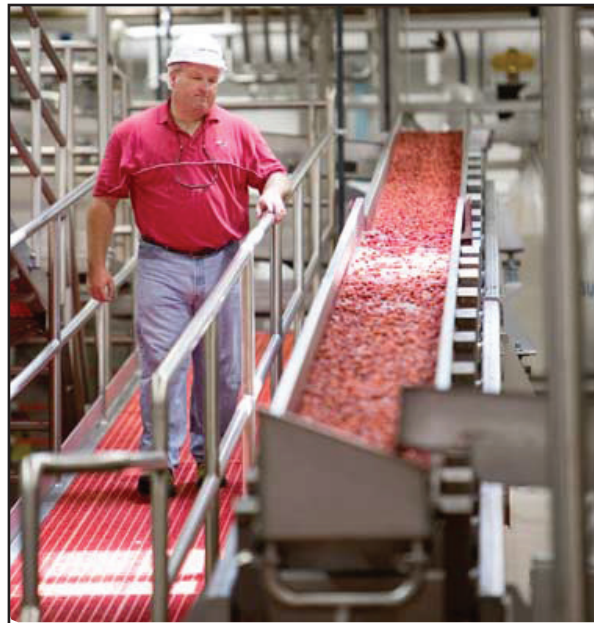
Bob Lowder d'Ocean Spray vérifie le flux de production de la ligne de transfert Iso-Flo à faible maintenance.
